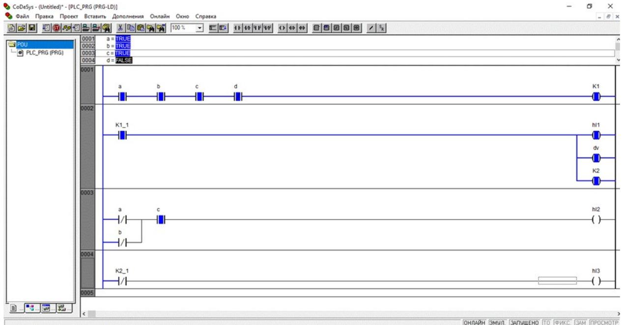
3. Если «заготовка НЕ установлена» ИЛИ «крышка НЕ закрыта» И нажата кнопка «Пуск», то загорится лампа «Ошибка», результат представлен на рисунке ниже
